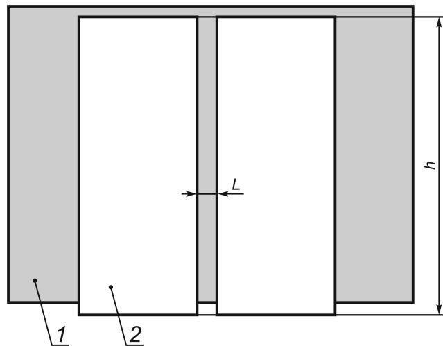
1 — протяженный излучатель; 2 — тепловой тест-объект толщиной 1 мм с переменной щелью (высота шторки  $h = \text{const}$ ,
